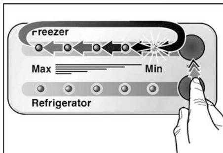
Значения температуры отображаются последовательно от самого высокого (Min) до самого низкого (Max).
