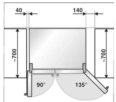
Если прибор устанавливается под полкой или шкафом, необходимо оставить небольшой зазор, чтобы при необходимости прибор можно было извлечь из ниши.
